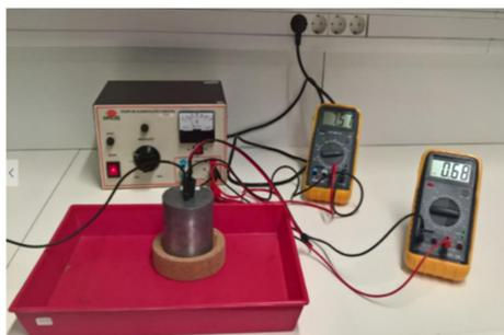
Figura 2. Montagem experimental da A.L. 3.2- Capacidade Térmica Mássica 10.º ano.
