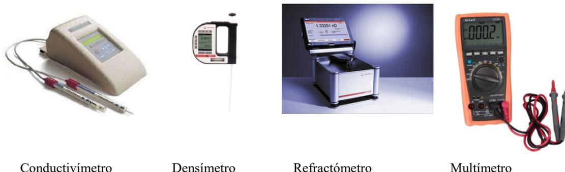
**Figura 3.** Imágenes de los instrumentos utilizados.
