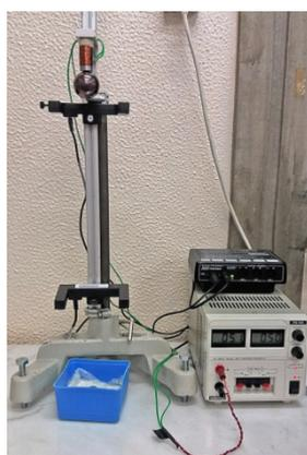
**Figura 1-** Montagem para determinação do  $g$  a partir da queda vertical de uma esfera.
