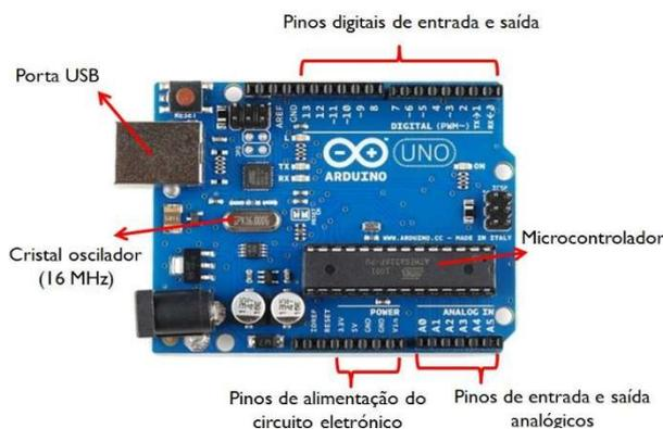
Figura 1. Placa Arduino Uno
