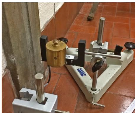
**Figura 2.** Massa cilíndrica de 500 g, bases da fotoporta, de alinhamento e largada.
